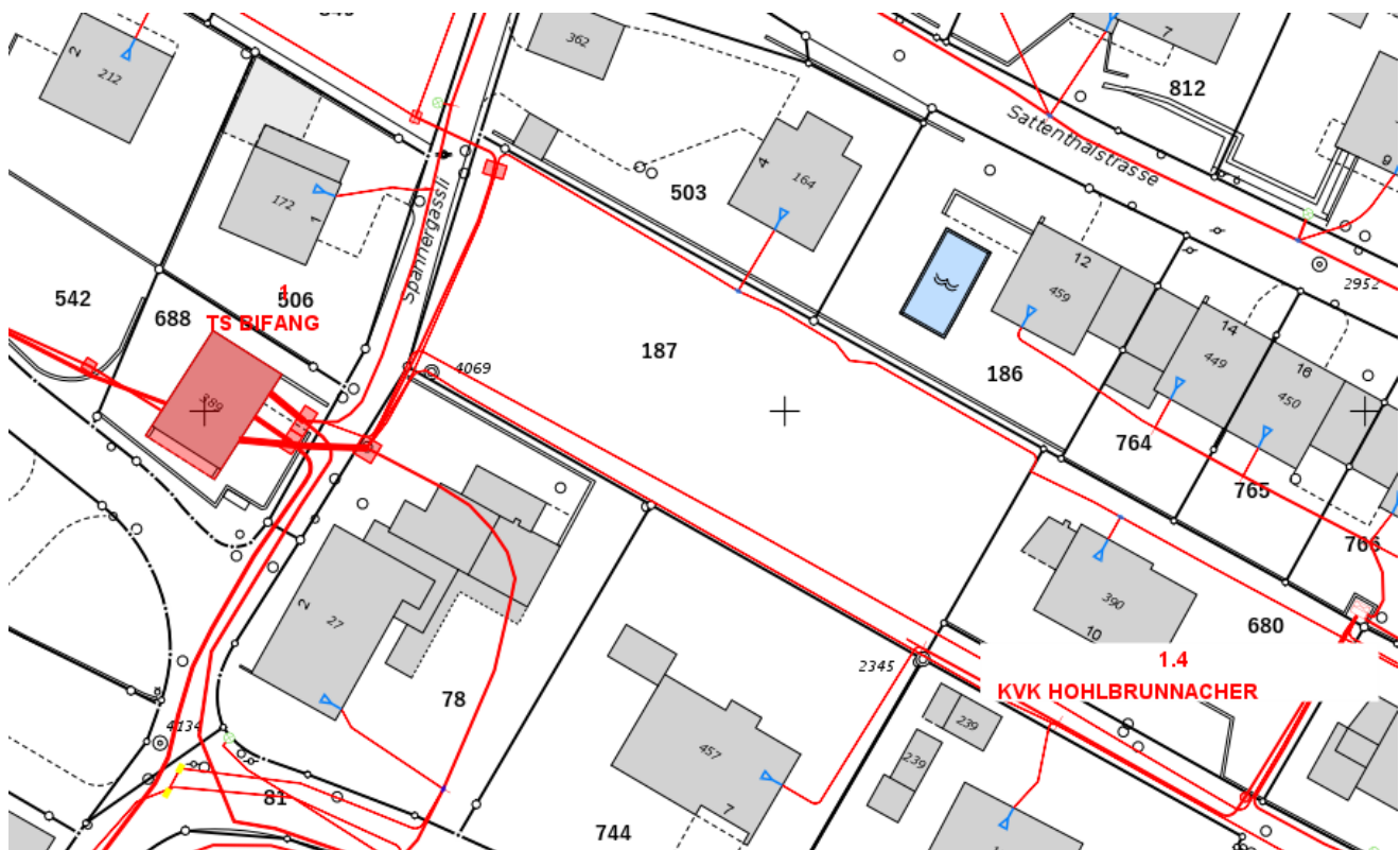
Bild: Trafo Bifang und Parzelle 187 mit bestehenden EW Leitungen
