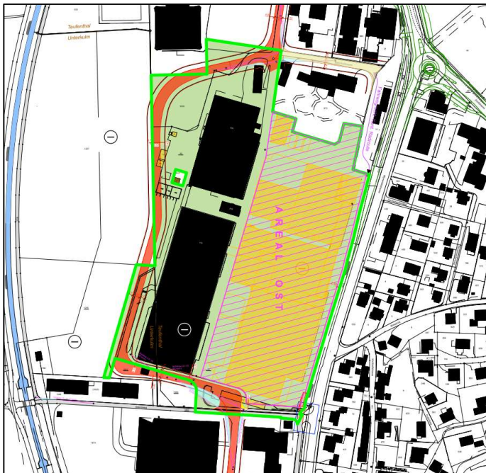
Abb. 6: geplante neue Strasse (rot)
